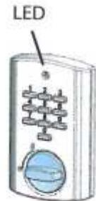
Hinweis: nach 5 Sekunden ohne Tastenbetätigung wird die Eingabe abgebrochen
